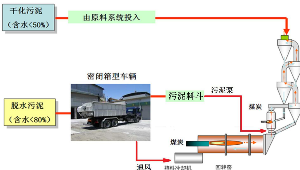
图 2.2-1 水泥窑协同处置固废流程简图
